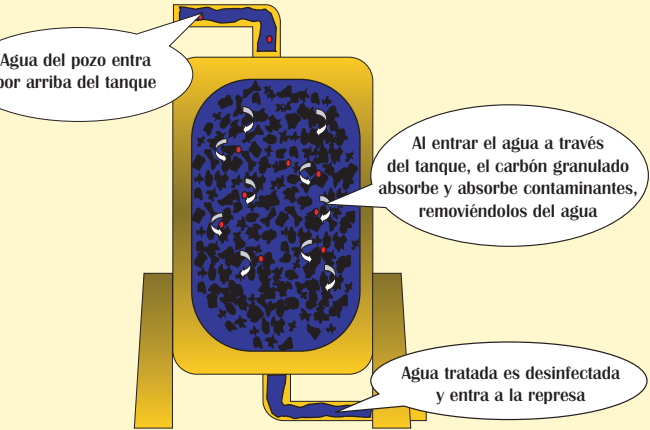
Tanques de Carbón Granulado Activado
